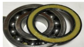
シール裏に玉と接触させないグリースを貯留
