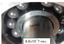
ナノダイヤモンドコート 潤滑OK ナノダイヤモンドコート 補給時期 補給の目安：トルクが初期の2倍、または玉光沢の減少時。
