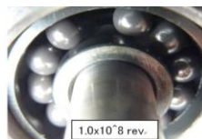
ナノダイヤモンドコート 潤滑OK ナノダイヤモンドコート 補給時期 補給の目安：トルクが初期の2倍、または玉光沢の減少時。
